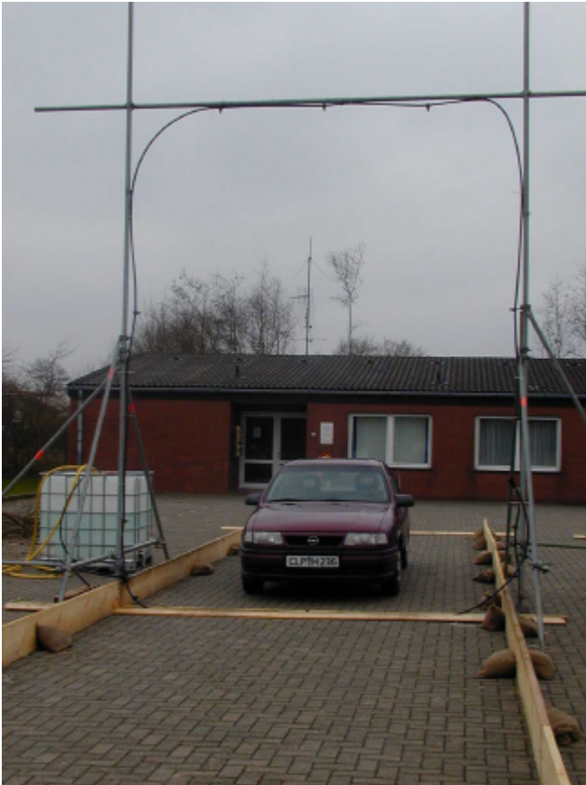
Bild oben: Gesamtansicht der Fahrzeug-Desinfektionsanlage, zu besichtigen beim Technischen Hilfswerk, Hohe Tannen 15, 49661 Cloppenburg.
